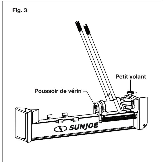
**⚠️ AVERTISSEMENT!** Ne JAMAIS essayer de retirer une bûche coincée dans la fendeuse en forçant le vérin hydraulique pour fendre la bûche.
