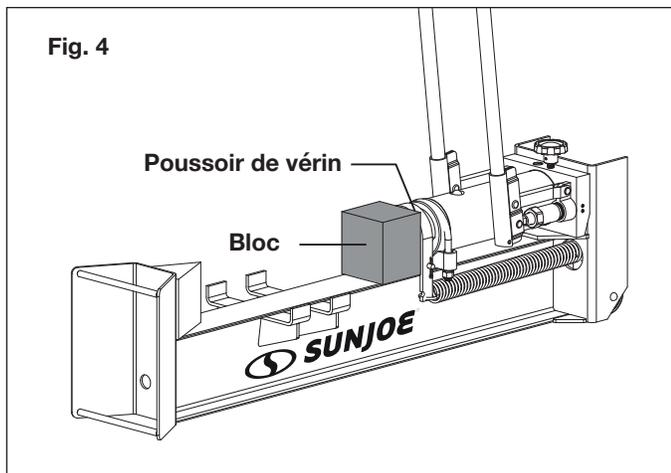
**REMARQUE :** les surfaces du ou des blocs utilisés pour rallonger la tige de piston doivent toutes être plates.
