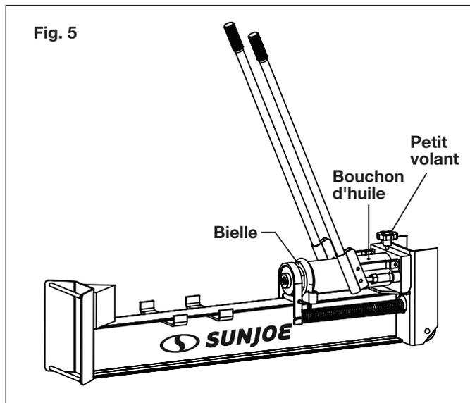
3. Tournez le petit volant aussi rapidement que possible dans le sens contraire des aiguilles d'une montre. La bielle rentrera dans la pompe hydraulique et expulsera l'air du vérin à travers le trou du bouchon d'huile.
